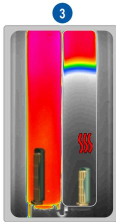
Датчик входного бака реагирует на снижение температуры воды и включает ТЭН. Он будет работать до тех пор, пока холодная вода не начнет поступать в выходной бак
