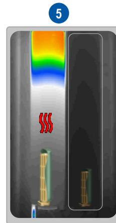
Датчик выходного бака реагирует на снижение температуры воды и включает ТЭН, при этом ТЭН входного бака выключается
